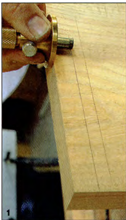
1 Разметка двух линий заплечиков поперёк доски. Первая — на полную глубину паза, вторая — на 2/3 этой глубины.
