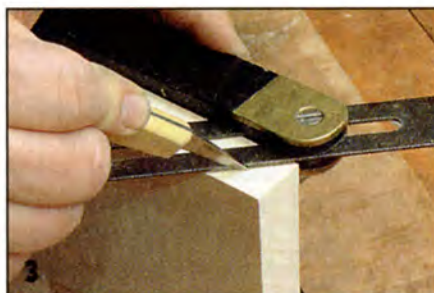
На боковых краях размечают соединение «на ус» под углом 45° крайних шипов от лицевого ребра до линии запечиков на противоположной пласте.
