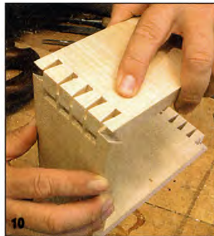
Насухо детали соединяют только до половины, чтобы не повредить шипы.
