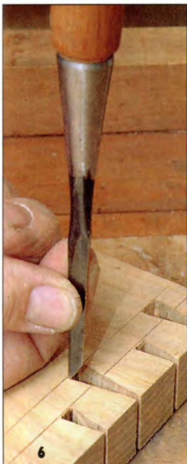
Основания пазов подрезают до линии разметки.
