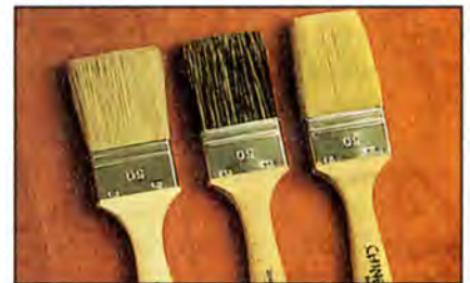
Плоские кисти, слева направо: из светлой свиной щетины, из жёсткой серой щетины (для работы с дисперсионными красками) и из синтетического волокна.
