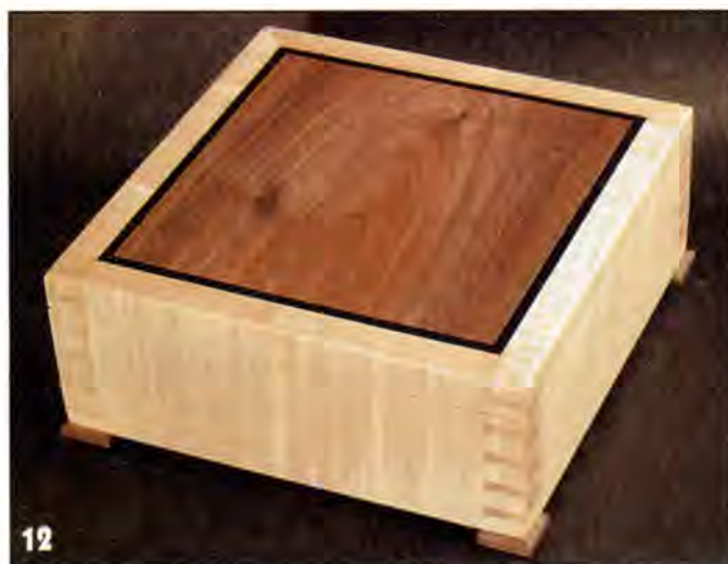
На шкатулке для украшений «ласточкин хвост», соединённые «на ус» по краям стенок смотрятся прекрасно.
