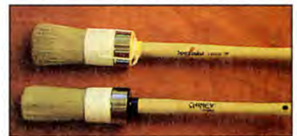
Круглые кисти из полиэфирного волокна для работы с акриловым лаком.
