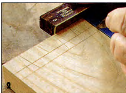
2 «Хвосты» размечают поочередно до линий заплечиков.
