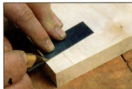
«Хвосты» размечают по специальному угольнику с уклоном линейки 1:8.
