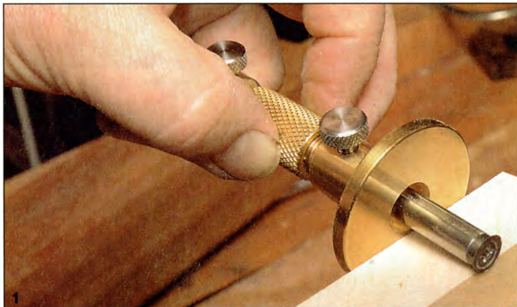
Выставляют рейсмус по толщине смежной доски.
