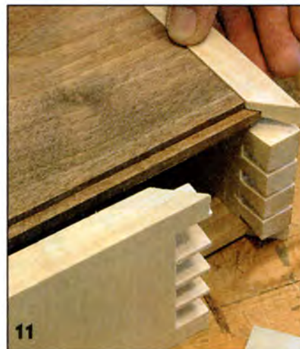
Окончательно собирают шкатулку вокруг панели-крышки.
