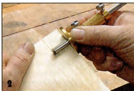
Линию запечика размечают от подготовленного торца.
