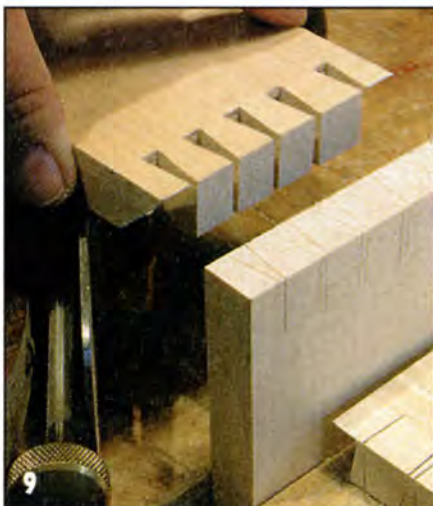
Доска с пазами служит шаблоном для разметки ответных шипов.
