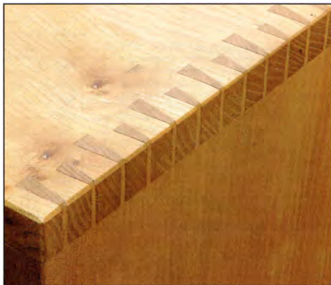
Декоративное соединение «ласточкин хвост» (или «зуб гончей») — впечатляющий вид угла шкафика.
