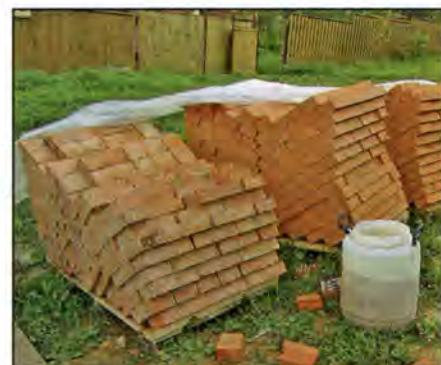
Нужны будут кирпич полнотелый рядовой (слева) и кирпич печной термостойкий (справа).
