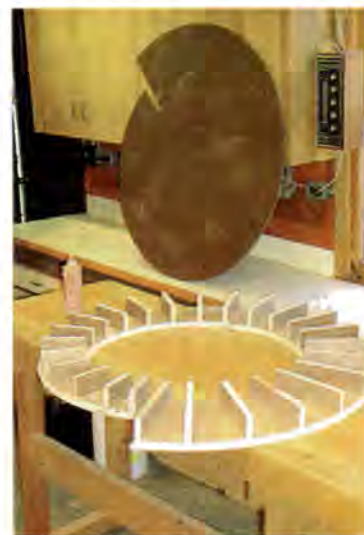
Внутренние перегородки устанавливают радиально (как в этом столике) или в виде решётки (в прямоугольном изделии).
