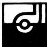
Этот символ на ковровом покрытии означает, что оно «не боится» нагрузки от роликов кресел.
