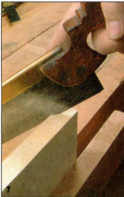
Особое внимание надо обратить на то, чтобы вначале запиливания «на ус» пила не подпрыгивала.
