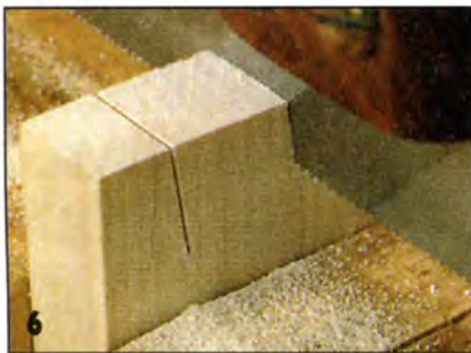
Чтобы уменьшить вибрацию доски при пилении, её зажимают в тисках как можно ниже.
