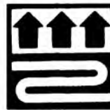
Этот символ означает, что ковровое покрытие можно использовать в помещениях с обогреваемым полом.
