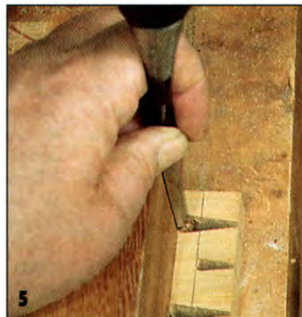
5 Технологический блок позволяет направить стамеску точно под прямым углом к пласти заготовки.
