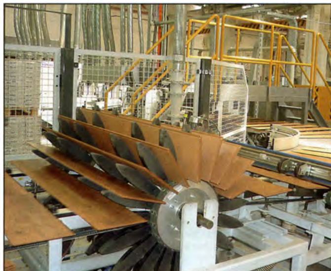
Линия обработки кромок ламината воском для обеспечения их влагостойкости.
