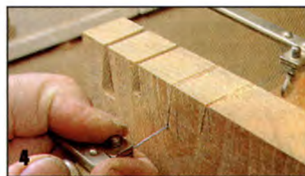
4 Из пазов выпиливают древесину лобзиком или лучковой пилой.
