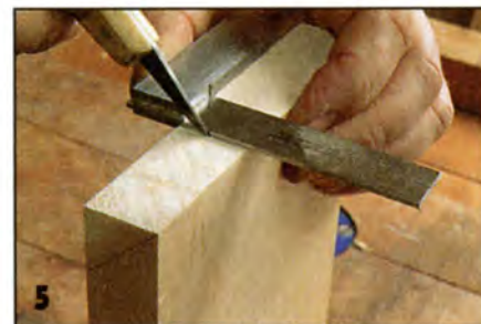
Разметку концов «хвостов» выполняют поперёк доски по обычному угольнику.
