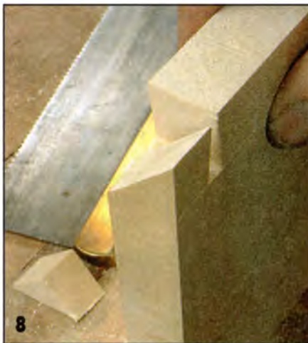
Получился скошенный шип для соединения «на ус» на краю детали.
